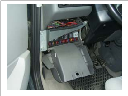
Sicherungen hinter Ablagefach, links vom Fahrer
