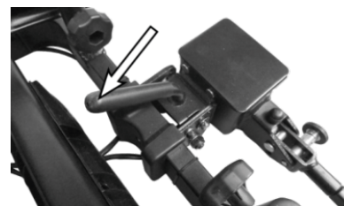
Figura 17: Meccanismo di ribaltamento
