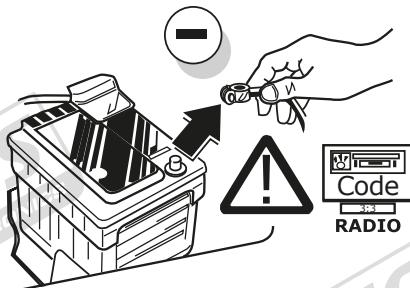
**DE** Um Störungen und Schäden am Bordnetz zu vermeiden, muss die Massepolklemme unbedingt vor Beginn aller Arbeiten von der Fahrzeughilfsbatterie getrennt werden! Insbesondere bei Arbeiten und Anschlüssen am CAN-Datenbus kann bei nicht abgeklemmter Batterie sowohl das Anhängermodul als auch das fahrzeugeigene Bordnetzsteuergerät beschädigt werden! Bitte Herstellervorschriften beim Ab- und Anklemmen der Fahrzeughilfsbatterie beachten!
