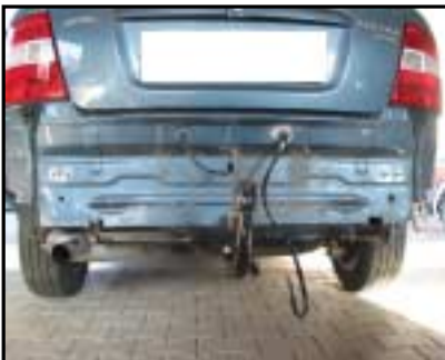
Anbau der AHK, Kabeldurchführung
