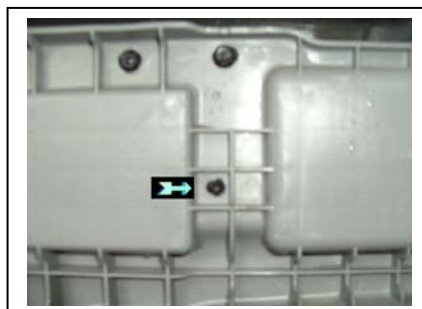
Verbindungsstecker für PDC, außen Kunststofffeder zusammendrücken und ausclippen
