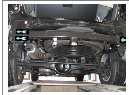
AHK Montage, AHK-Träger mit Winkel von hinten fixieren, Schrauben vom alten Träger
