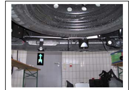
AHK Montage, 1.Strebe links mit Schrauben von innen nach außen mit den Laschen des AHK-Träger
