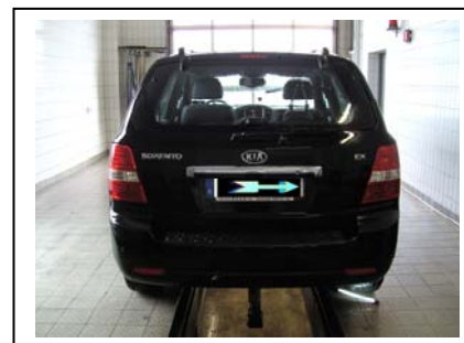
Ausschnitt für Stoßstange im Kunststoff herstellen, Dremel o.ä. von Vorteil, Ausschnitttiefe von 15mm nicht genug, ca. 30mm bis zum ersten Knick
