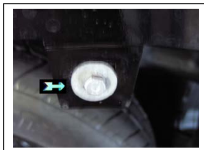
AHK Montage, 1.Strebe rechts mit Schrauben von innen nach außen mit den Laschen des AHK-Träger
