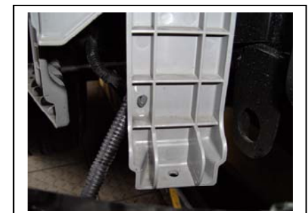
Kabelhalter für PDC, außen Kunststofffeder zusammendrücken und ausclippen
