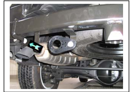
AHK Montage, 1.Strebe links mit Schrauben von innen nach außen mit den Laschen des AHK-Träger
