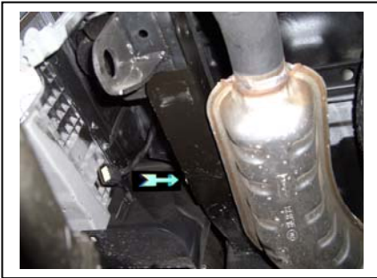
AHK Montage, 1.Strebe links mit Schrauben von außen nach innen, Fixierung
